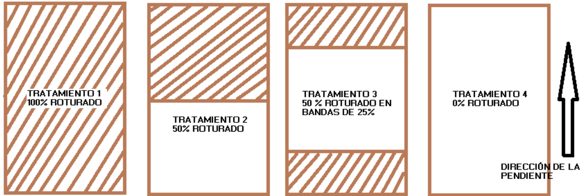
Figura 3. Representación de los niveles de roturación del suelo y la dirección de la pendiente.
